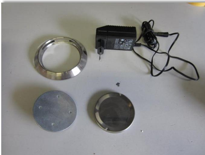
**Alle** losen Teile, wie z.B. Wägeplatte, Träger, Schirmring, etwaig Wägeraumabdeckbleche etc. aus dem Wägeraum entfernen.
